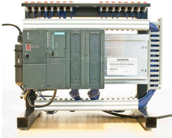
Abb. 4: Speicherprogrammierbare Steuerung (SPS), ein Gerät zur Steuerung einer Maschine oder Anlage, das auf digitaler Basis programmiert wird.
